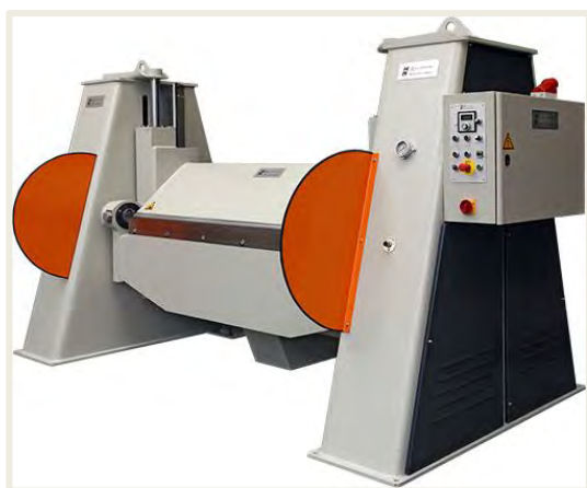
Für Arbeitsbreiten von 500 bis 8.000 mm und Blechstärken von 1,0 bis 25,0 mm
