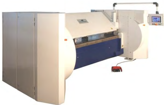
Müheloses Biegen für den anspruchsvollen, harten Arbeits-einsatz: MAK 4 für Arbeitsbreiten von 2.000 bis 5.000 mm und Blechstärken von 3,0 bis 6,0 mm
