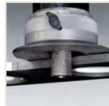
Stirnseitiges Schleifen 0° mit Diamantzylinder
